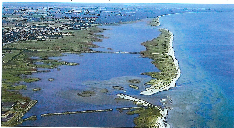
Fig. 5.44: Ølsemagle revle i Køge Bugt. Ølsemagle revle er en ung barriereø, der er dannet gennem de seneste 100 år, hvor den er vokset gradvist i både højde og bredde. Lagunegabet mod syd er lukket naturligt, og med tiden vil hele lagunen formentlig fyldes op med sediment, så revlen ikke længere ligger fremskudt, men udgør selve kystlinjen.
