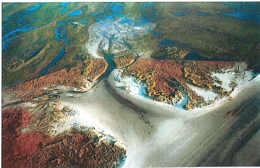
Fig. 5.38: Gennembrud af dige og klitrække ved Skallingen, den jyske vestkyst. I forbindelse med gennembruddet skyller bølgerne store mængder sand ind bag klitterne og danner såkaldte overskylstunger. På erosionskyster har det vist sig, at overskylstunger er i stand til at opbygge sediment, selvom resten af kystlinjen mister sediment. (Foto: Niels Vinther).
