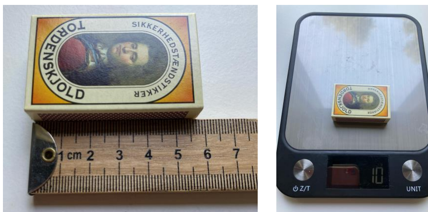
Figur 1: Måling af de fysiske størrelse længde (billede til venstre) og masse (til højre) med henholdsvis lineal og vægt.
