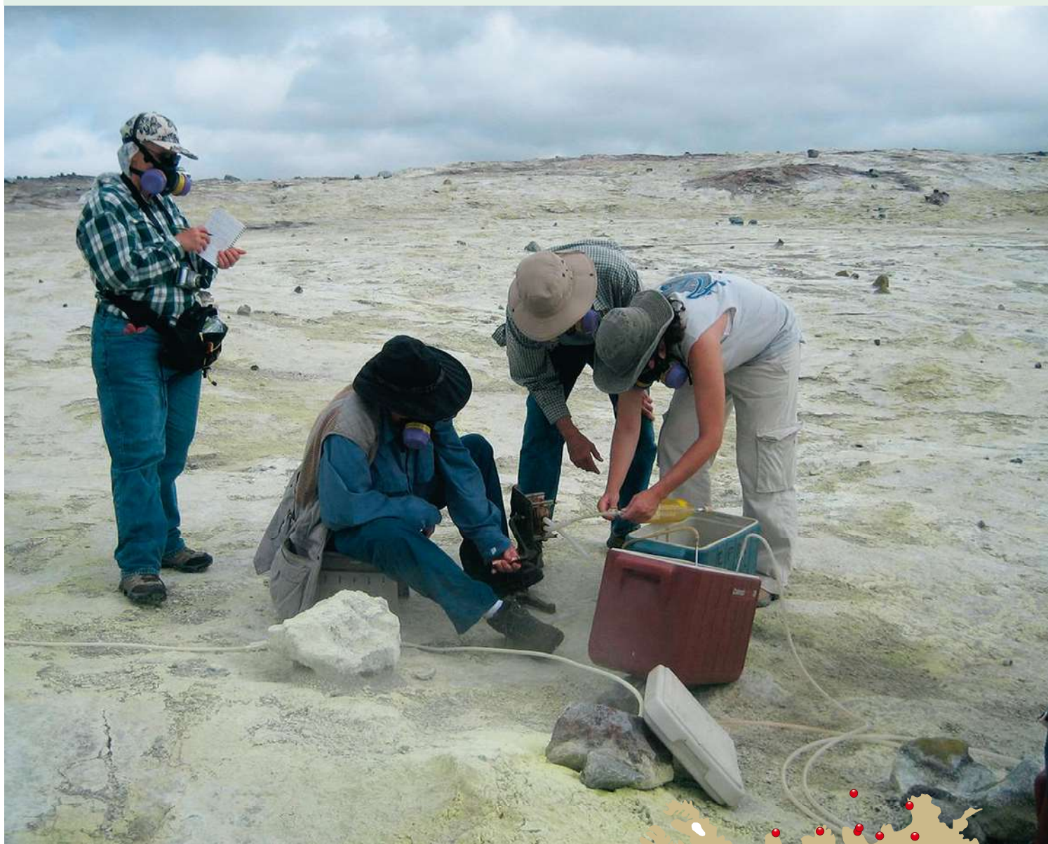
Indsamling af prøver af gasarter i et vulkansk område på Hawaii. Gassen opsamles her i beholdere og analyseres senere i et laboratorium.
