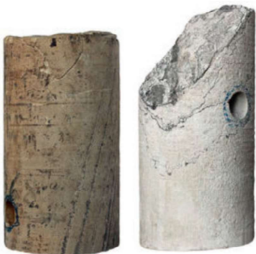
Fig. 7.19: Kalkprøver med og uden olie. Den mørke kalkprøve indeholder mange mikroskopiske oliedråber. (Foto: Geologisk Museum København).
