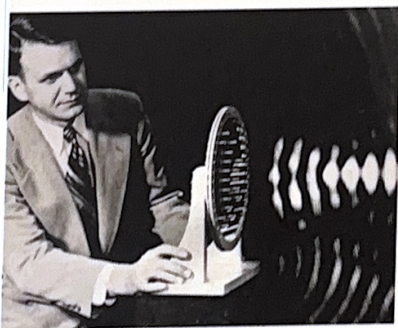
Fig. 2.62 Normalt kan lydbølger ikke ses, men kun høres. Ved hjælp af en speciel teknik er det muligt at se lydbølgernes fortyndinger og fortætninger af luften.
