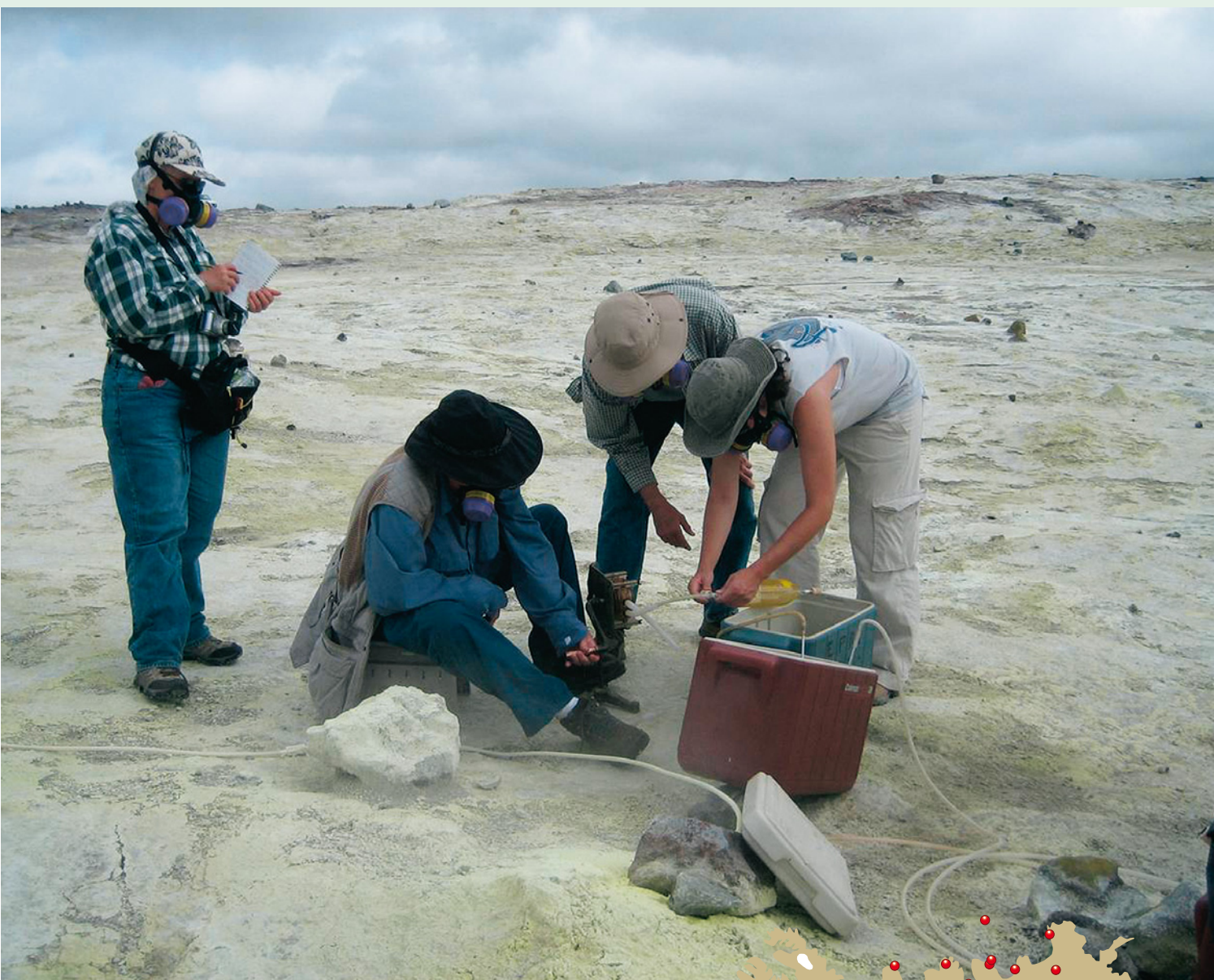
Indsamling af prøver af gasser i et vulkansk område på Hawaii. Gassen opsamles her i beholdere og analyseres senere i et laboratorium.
