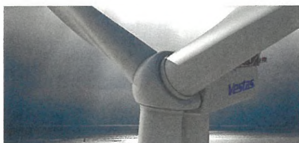
FIGUR 2.48 ◀ En konventionel vindmølle har en relativt begrænset effekt i forhold til et gammeldags kulfyret kraftværk. Der skal op imod 300 vindmøller til at levere samme effekt som et konventionelt kraftværk, idet vindmøllens effekt kun er ca. 3 MW. Derfor opsættes vindmøller ofte i stort antal i såkaldte vindmølleparker. Der arbejdes løbende på at udvikle større og mere effektive vindmøller. Det danske firma Vestas har udviklet såkaldte megamøller med en effekt på op til 10 MW.
