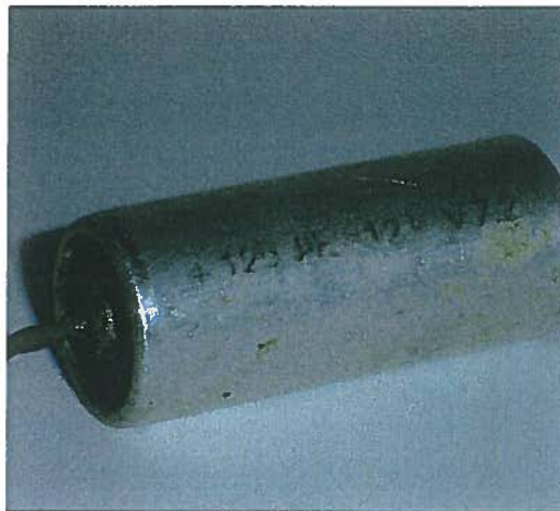
Figur 30. Gamle kondensatorer fra før 1988 kan indeholde PCB. Miljøstyrelsen har udgivet en fortegnelse over de miljøfarlige typer.
