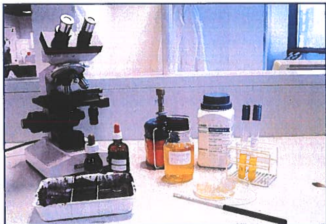
Figur 196. Redskaber i det mikrobiologiske laboratorium. Mikroskop, farvevæske til at identificere celler med ved mikroskopering, reagensglas med næringsbouillon til dyrkning af bakterier, gasflamme til desinfektion, podenål til overførsel af bakterier, agarplade og næringsagar til fremstilling af agarplader.
