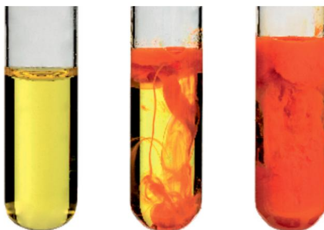
Figur 142. Bradys reaktion. Reagenset 2,4-dinitrophenylhydrazin har en klar gul farve. Ved tilsætning af aldehydet ethanal dannes et orange bundfald.
